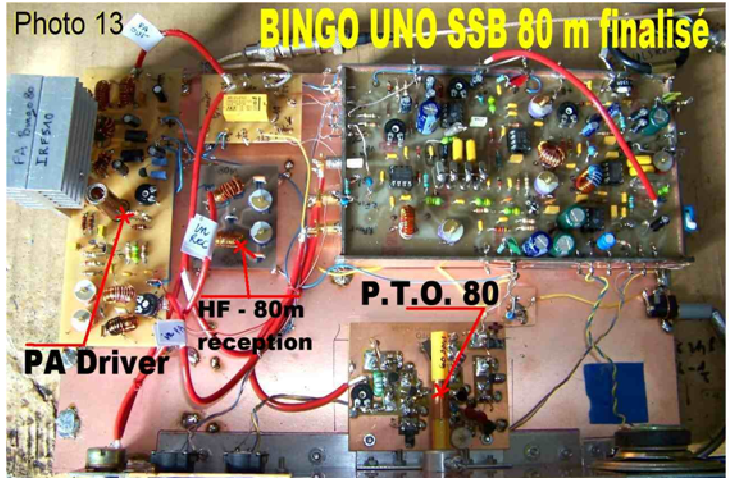
(Photo 13) : Le BINGO UNO SSB 80m est entièrement finalisé, le câblage terminé. Tel quel il permet le trafic en QRP 80 m comme une station standard. Avec ses 10 watts HF les QSO sont faciles.
