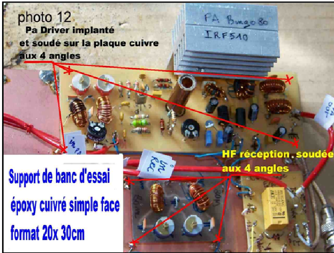
(Photo 12) : Méthode de fixation des nouvelles platines implantées, HF réception et Driver PA 80 m, tout est soudé aux 4 angles sur des picots de 15 mm de long.
